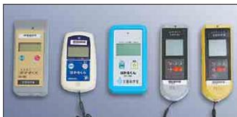
②空間の放射線量を調べる 簡易放射線測定器「はかるくん」(シンチレーション式サーベイメータ) 空間の放射線量を測るもの。身の周りの放射線(ベータ( \beta )線、ガンマ( \gamma )線)を測ることができる学習用の測定器です。(単位: \mu\text{Sv/h} )
