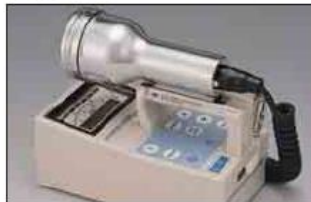
①放射性物質の有無を調べる ガイガーミュラーカウンタ(GM計数管)など 放射線の数を測るもの。物質に放射性物質が付着しているかを調べるのに利用します。 (単位:cpm*など) *cpm:1分間に計測された放射線の数
